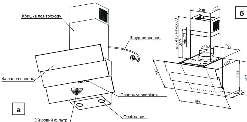
Рис. 1: а) загальний вид витяжки; б) габаритні розміри.
