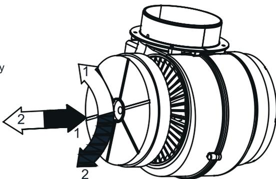
**Рис. 9.** Заміна вугільного фільтра
